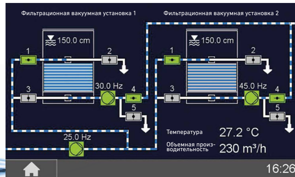
Цифровая визуализация процесса на сенсорном экране компьютера управления для фильтрационной вакуумной установки Ospra 2
