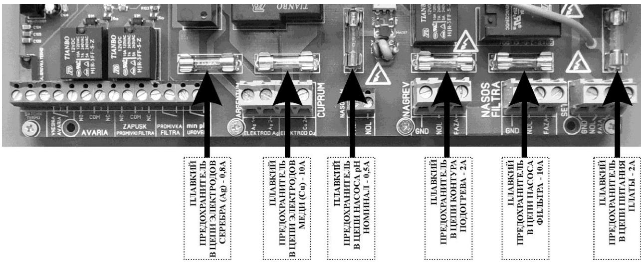
**!!!ВНИМАНИЕ!!!** Замена плавких предохранителей производится только при полностью обесточенном(отключенным от питающей электрической сети) электронном блоке управления.
