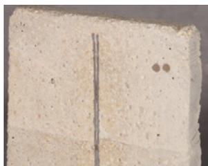
Соединение двух пластин AQUAFIN-CJ5 внутри секции бетона
