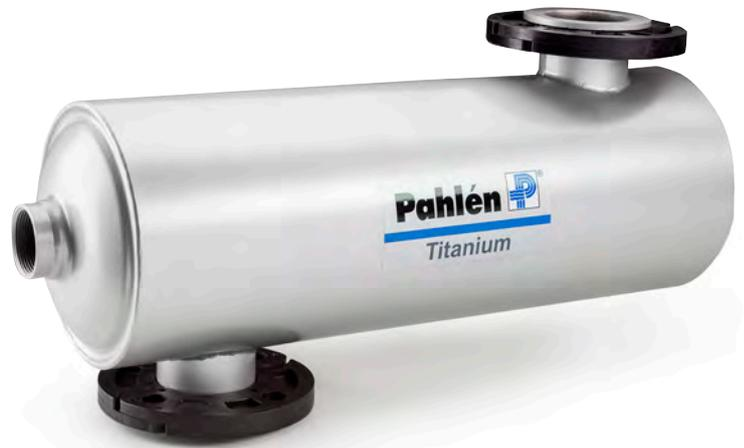
Maxi-Flo Titanium - это трубчатый теплообменник с витыми трубками для эффективного нагрева. Титан - идеальный материал, когда используется солевой хлоратор (электролизер).
