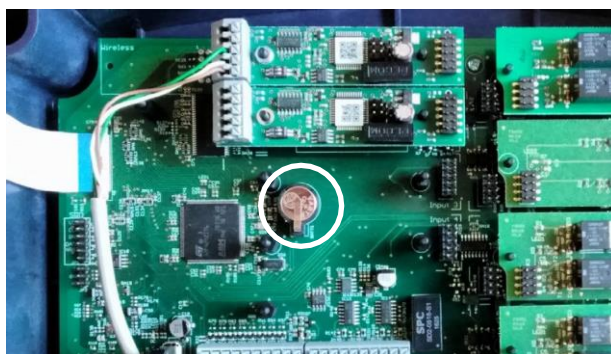
Рис. 31: Миниатюрный элемент питания CR1220
