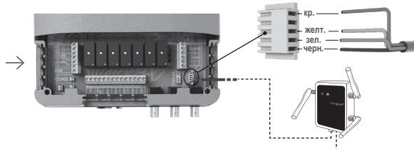
Выключите устройство с помощью переключателя ВКЛ / ВЫКЛ и достаньте вилку из розетки. С помощью отвертки снимите крышку, закрывающую разъемы.
