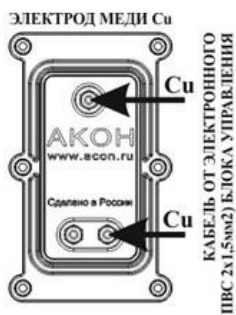
ПОДКЛЮЧЕНИЕ КАБЕЛЯ К ЭЛЕКТРОДУ МЕДИ Cu В SilverPRO LIGHT AUTO SPL 5.1
